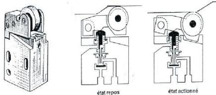
Tant que le détecteur n'est pas actionné, l'air sous pression ne peut pas gagner la sortie.
