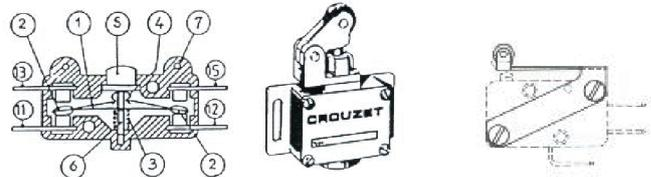
En actionnant le bouton central (5), la lame élastique (1) portant les contacts électriques (2) se déforme. La liaison électrique entre les bornes (11) et (12) est rompue et la liaison entre les bornes électriques (13) et (15) est établie.
