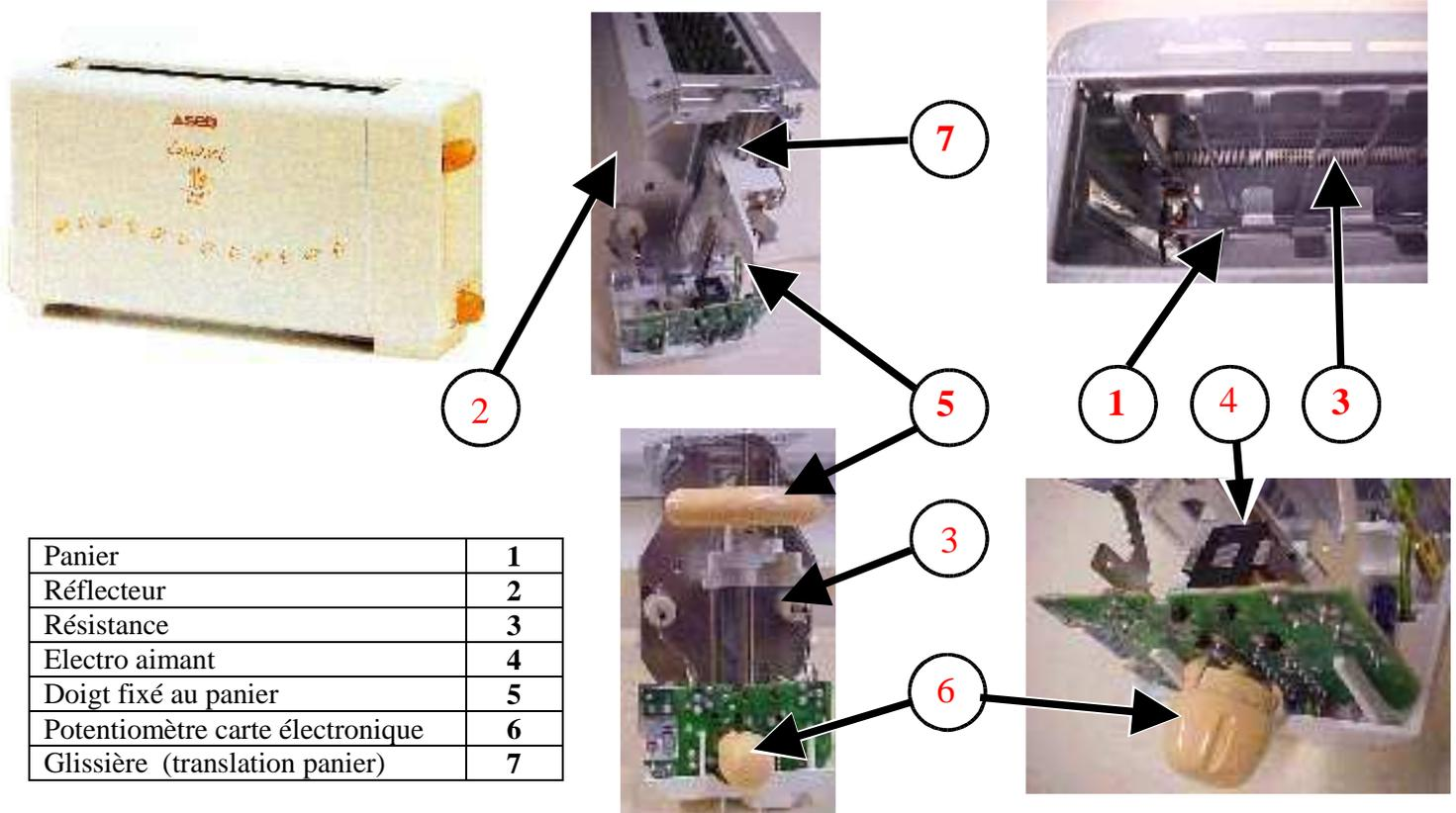
6.3. Indiquer dans le tableau ci-dessous l'emplacement dans la chaîne fonctionnelle des différents éléments repérés ci-dessus.
