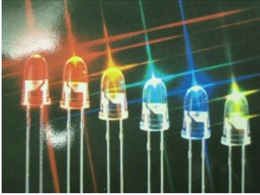
هو ثنائي قطب غير نشيط و غير تماثلي ، لا يسمح بمرور التيار الكهربائي إلا إذا مان مستقطب في المنحى المار شريطة أن يتجاوز التوتر  $U$  بين مرطيه عتبة التوتر  $U_s$ . في هذه الحالة عندما يمر فيه التيار الكهربائي ( بعض الميلي أمبيرات ) فإنه يضيء.
