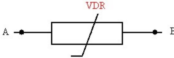
يتكون المركب الكهربائي VDR من حبات شبه موصلة grains semi conducteur مكنة بواسطة ملط Liant و توجد في أغلب الأحيان على شكل قرص أسطواناني ملون. عند دراسة الممييزة  $U = f(I)$  نحصل على :
