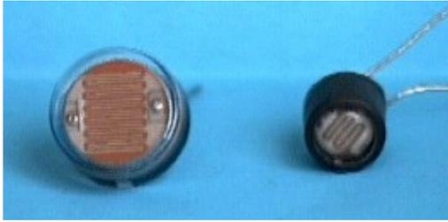
المقاومة الضوئية ثنائي قطب ، تتغير مقاومته حسب الإضاءة التي يتلقاها. وفي الظلام تقدر هذه المقاومة بحوالي  $1M\Omega$  وتقارب  $100\Omega$  عندما تكون مضاءة بمصباح جيبى ، أو بالأشعة الضوئية.
