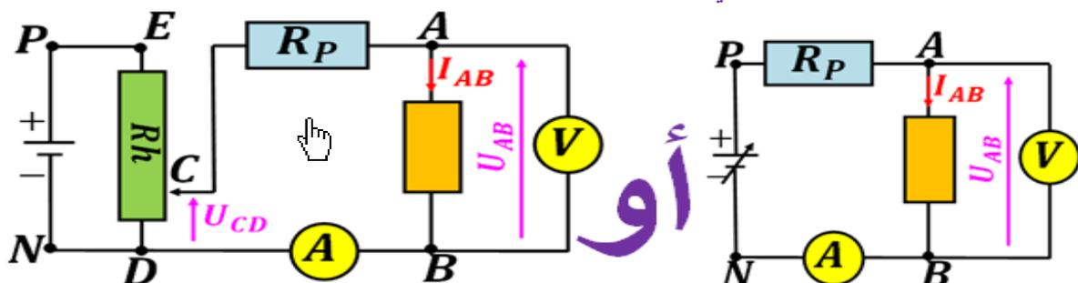
ندمج ثنائي القطب  $(AB)$  في أحد التركيبين بحيث يمر فيه تيار كهربائي من  $A$  نحو  $B$  ( أي  $U_{AB} > 0$  و  $I_{AB} > 0$  ) ، ونقوم بتغيير التوتر  $U_{AB}$  بتحريك الزايقة أو زر ضبط التوتر . ثم نقلب ربط ثنائي القطب  $(AB)$  وأجهزة القياس ( غير الرقمية ) فيمر فيه تيار كهربائي من  $B$  نحو  $A$  ( أي  $U_{BA} > 0$  و  $I_{BA} > 0$  ) . فنحصل على **مميزة ثنائي القطب  $(AB)$**  .
