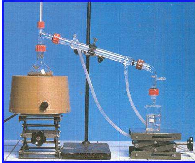
الوثيقة -12- التقطير المائي لأزهار الخزامى
