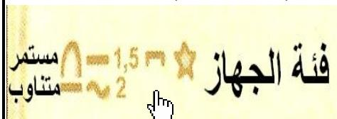
مستعمل الجهاز (القراءة) . ويحدد بالعلاقة التالية:  $\Delta I = \frac{\text{الفئة} \times \text{العيار}}{100}$
