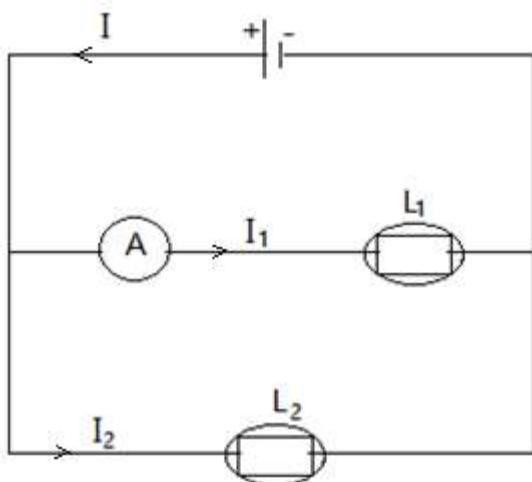
2- تحديد منحى التيارات الكهربائية  $I$  و  $I_1$  و  $I_2$  أنظر الشكل جانبه .
