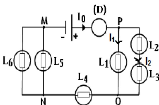
عند قياس  $I_0$  شدة التيار الكهربائي في الفرع الرئيسي من الدارة بواسطة الجهاز (D) فتته  $X=1,5$  ، أشارت إبرته إلى التدريجة 80 على الميناء الذي يحتوي على 100 تدريجة ، حيث العيار المستعمل هو 0,5A
