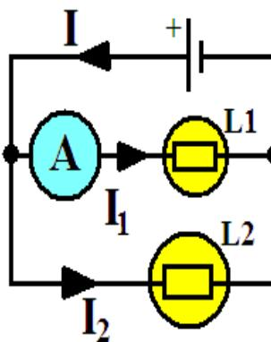
نعتبر الدارة الكهربائية جانبية ، حيث تجتاز مقطعاً من الفرع الرئيسي خلال كل  $10\text{min}$  كمية الكهرباء  $Q=3000\text{C}$  .
