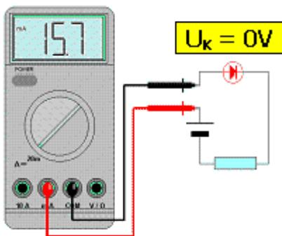
في أغلب الأحيان نقبل أن التوتر الكهربائي بين مربطي جهاز الأمبير متر وقاطع التيار منعدم.
