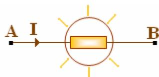
يمكن الالاتصال الكهربائي بين نقطتين من دارة كهربائية من مرور التيار الكهربائي من نقطة نحو أخرى.
