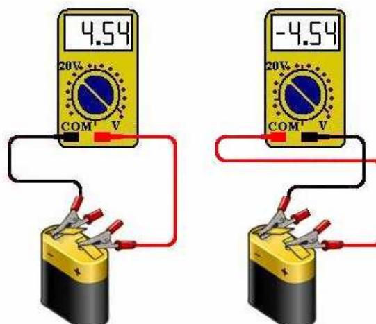
التوتر الكهربائي بين نقطتين A و B من دارة كهربائية مقدار جبri:  $U_{AB} = -U_{BA}$ .
