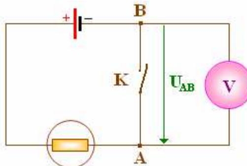
﴿عندما يكون قاطع التيار مغلقاً، فإن  $U_{AB} = 0$  نقول إن للنقطتين نفس الجهد الكهربائي. ونكتب
