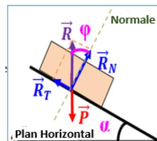
On a alors  $\vec{R} = \vec{R}_N + \vec{R}_T = \vec{R}_N + \vec{f}$  avec  $\varphi$  est l'angle de frottement
