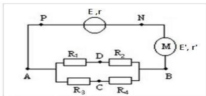
1- Calculer la résistance équivalente  $R_{eqAB}$  à la portion AB. Représenter le circuit équivalent.
