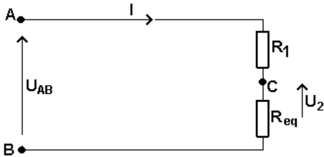
$R_1$ ,  $R_2$  et  $R_3$  ne sont pas parcourues par le même courant. Les résistances  $R_1$  et  $R_2$  ne sont pas en série. Il faut remplacer le bloc ( $R_2 // R_3$ ) par sa résistance équivalente  $R_{\text{eq}}$  qui, elle, est en série avec  $R_1$
