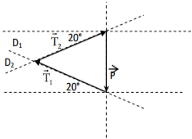
☞ La mesure directe de la longueur des vecteurs  $\vec{T}_1$  et  $\vec{T}_2$  donne 2,9 cm chacun soit une intensité égale à  $\frac{2,9 \text{ cm} \times 400 \text{ N}}{1 \text{ cm}} = 1160 \text{ N}$ . On trouve donc  $T_1 = T_2 = 1160 \text{ N}$
