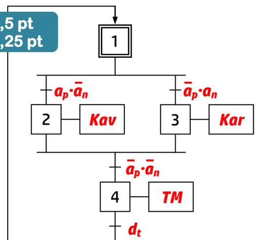
c. Etablir, d'après le grafctet de point de vue API (Zelio) ci-dessous, le programme de commande du moteur en langage à contacts (Ladder) :
