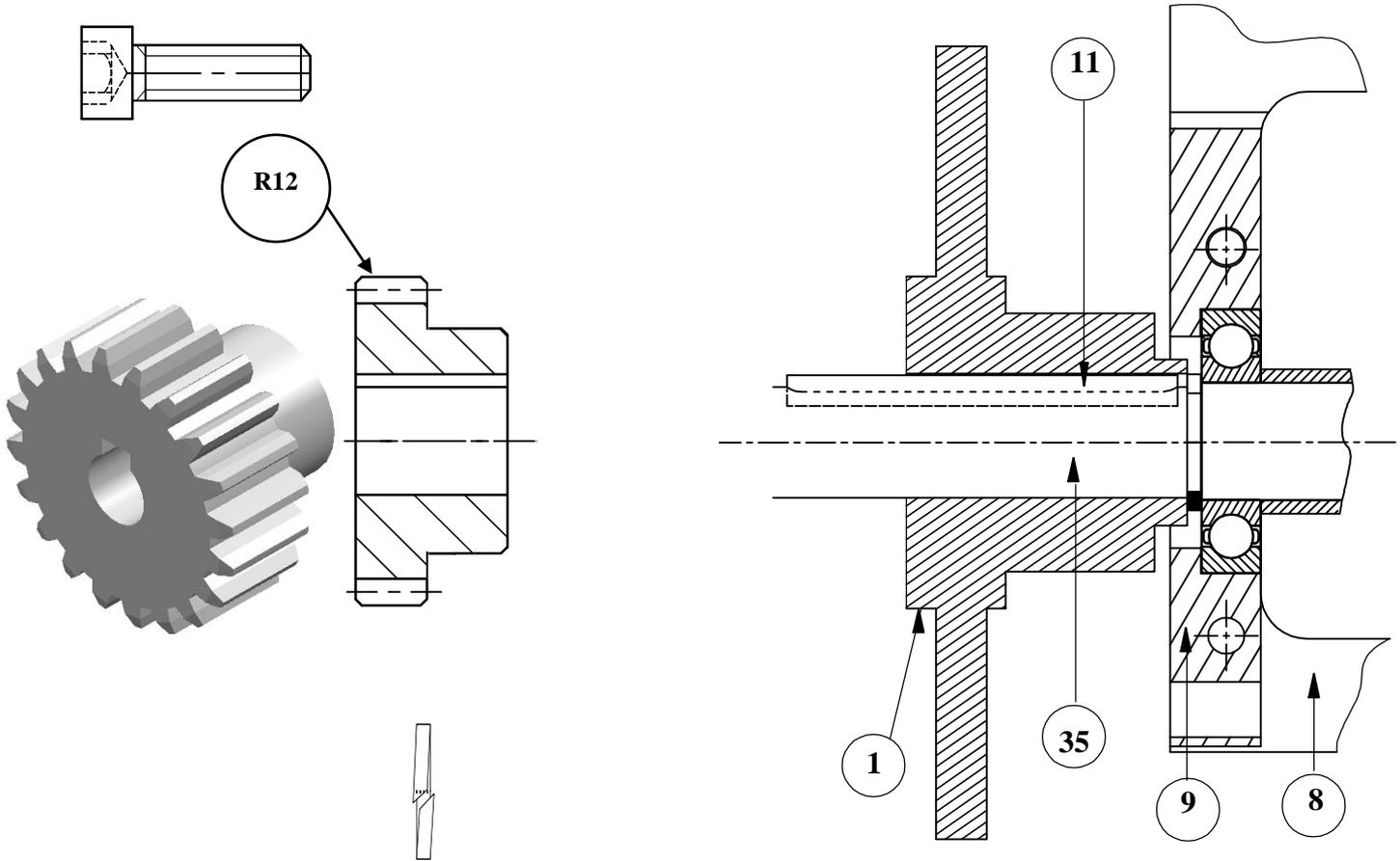
c. Cocher le type d'ajustement nécessaire au montage de la roue dentée R12 sur l'arbre à cames 35 : ...../1pt
