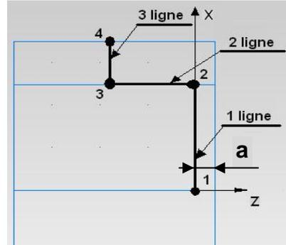
Nota : Usinage de face  $a=2mm$  ;
