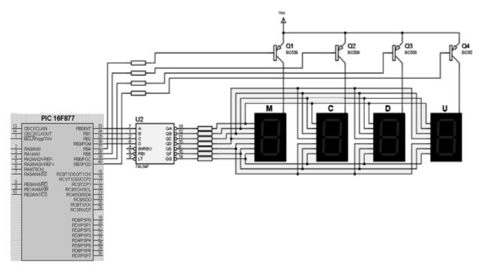
Le montage réalise un comptage de 0 à 9999. Le circuit U2 étant un décodeur BCD/7ségments ; les transistors Q de type PNP commandent la sélection des afficheurs
