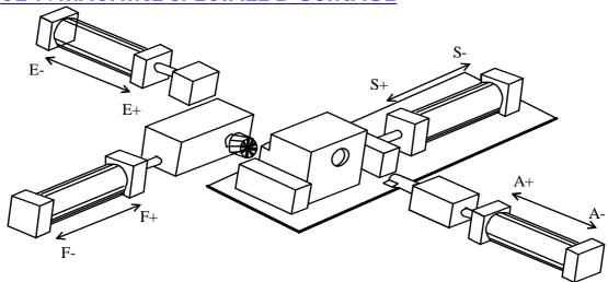
Cette machine effectue deux usinages: le fraisage (grâce au vérin F) et le lamage (grâce au vérin A) Les vérins S et E assurent respectivement le serrage et l'éjection
