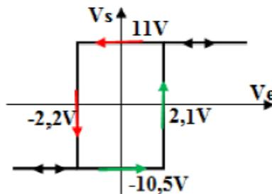
3. on a un comparateur à deux seuils de basculement. On appelle ce montage, comparateur non inverseur à hystérésis ou trigger de schmitt non inverseur.
