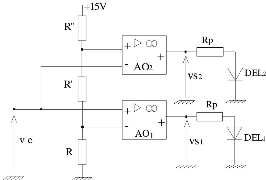
Les AOp sont parfaits et alimentés en +15V et 0V et leurs tensions de saturation valent 14V et 0V .
