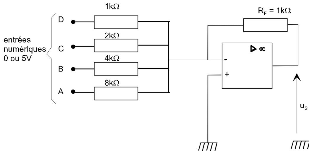
**1.** Th. De Millman :  $v_- = \frac{\frac{VD}{1} + \frac{VC}{2} + \frac{VB}{4} + \frac{VA}{8} + \frac{us}{Rf}}{\frac{1}{1} + \frac{1}{2} + \frac{1}{4} + \frac{1}{8} + \frac{1}{Rf}}$  avec Rf en KΩ
