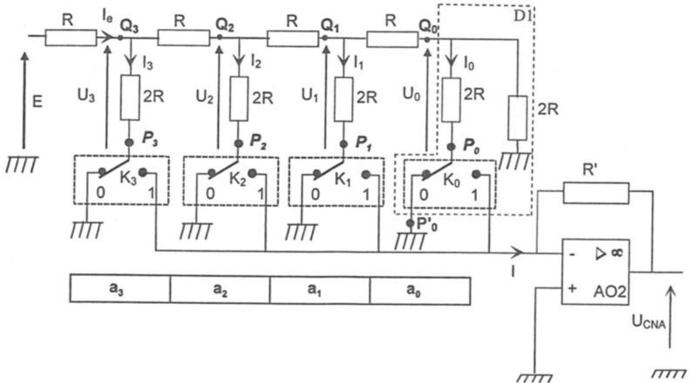
Pour  $i = 0, 1, 2$  ou  $3$ , la position de l'interrupteur  $K_i$  dépend de la valeur du bit  $a_i$  :
