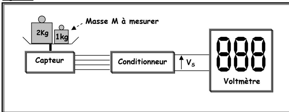
Le conditionneur permet d'avoir une tension  $V_S$  image de la masse  $M$  à mesurer. Le schéma du montage d'un tel conditionneur est celui de la figure 9. On considère que les AOP sont parfaits.
