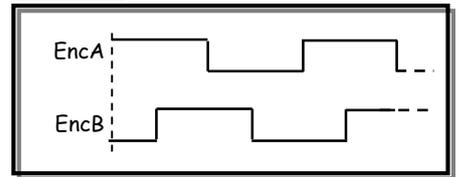
6. Le principe de la détermination de la position du curseur consiste, en l'accumulation des impulsions fournies par une piste, à l'aide d'un compteur/décompteur selon le montage de la figure 5.
