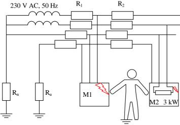
$Z=2000Ω, R_u=22Ω, l'impédance du corps humain vaut 1000Ω.$  Le défaut est franc. Les impédances de lignes  $R_1=1,5$  Ω et  $R_2=3,5$  Ω.
