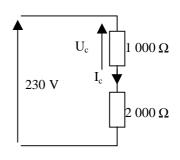
2. Déterminer la tension de contact subit par l'homme par rapport au sol lorsque la machine M2 est en défaut d'isolement.
