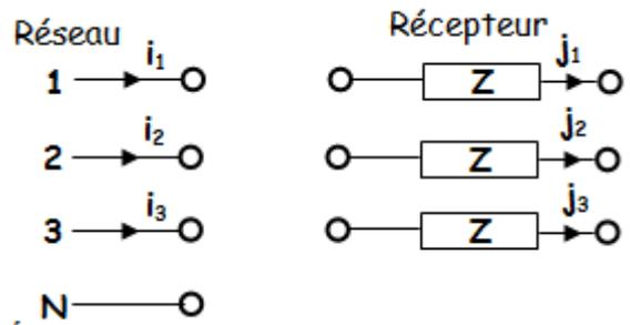
Le réseau et le récepteur peuvent se relier de deux façons différentes : en étoile ou en triangle.
