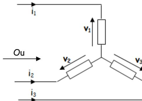
Comme il s'agit des mêmes impédances, de ce fait  $i_1 + i_2 + i_3 = 0$ , donc  $i_N = 0$ . Le courant dans le fil neutre est nul. Le fil neutre n'est donc pas nécessaire. Pour un système triphasé équilibré, le fil neutre ne sert à rien.
