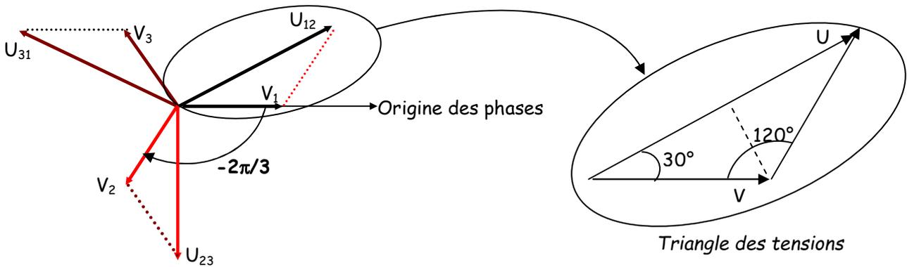
**Remarque :** On voit ainsi apparaître un nouveau système de tensions triphasées :  $u_{12}, u_{23}, u_{31}$ . La relation qui existe entre l'amplitude  $V$  et  $U$  se calcule facilement à partir du triangle des tensions :  $2.V.\cos(\pi/6) = U$  c'est à dire  **$U = \sqrt{3}.V$**
