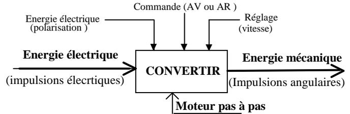
**Principe de fonctionnement d'un moteur pas à pas**
