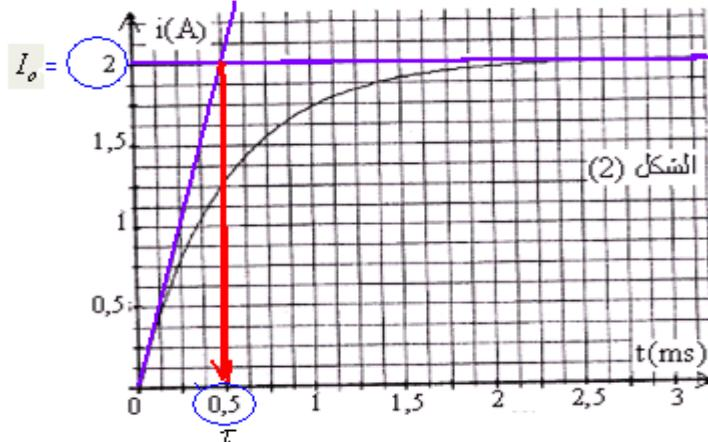
7) الوشيعة تقاوم إقامة التيار الكهربائي في الدارة.
