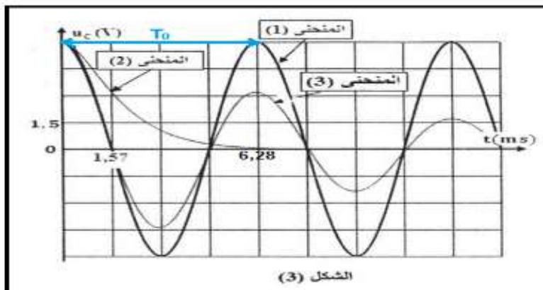
2.2. تأثير المقاومة على التذبذبات الكهربائية:
