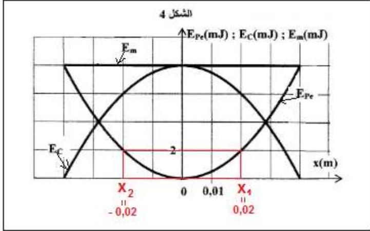
عند نفس اللحظة سرعة الجسم منعدمة ومنه تكون الطاقة الحركية منعدمة وبالتالي المنحنى 2 يوافق  $E_C$  الطاقة الحركية.
