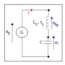
Pour avoir des oscillations électriques sinusoïdales il faut  $\frac{(r_3-k)}{L_3}=0 \implies r_3-k=0$
