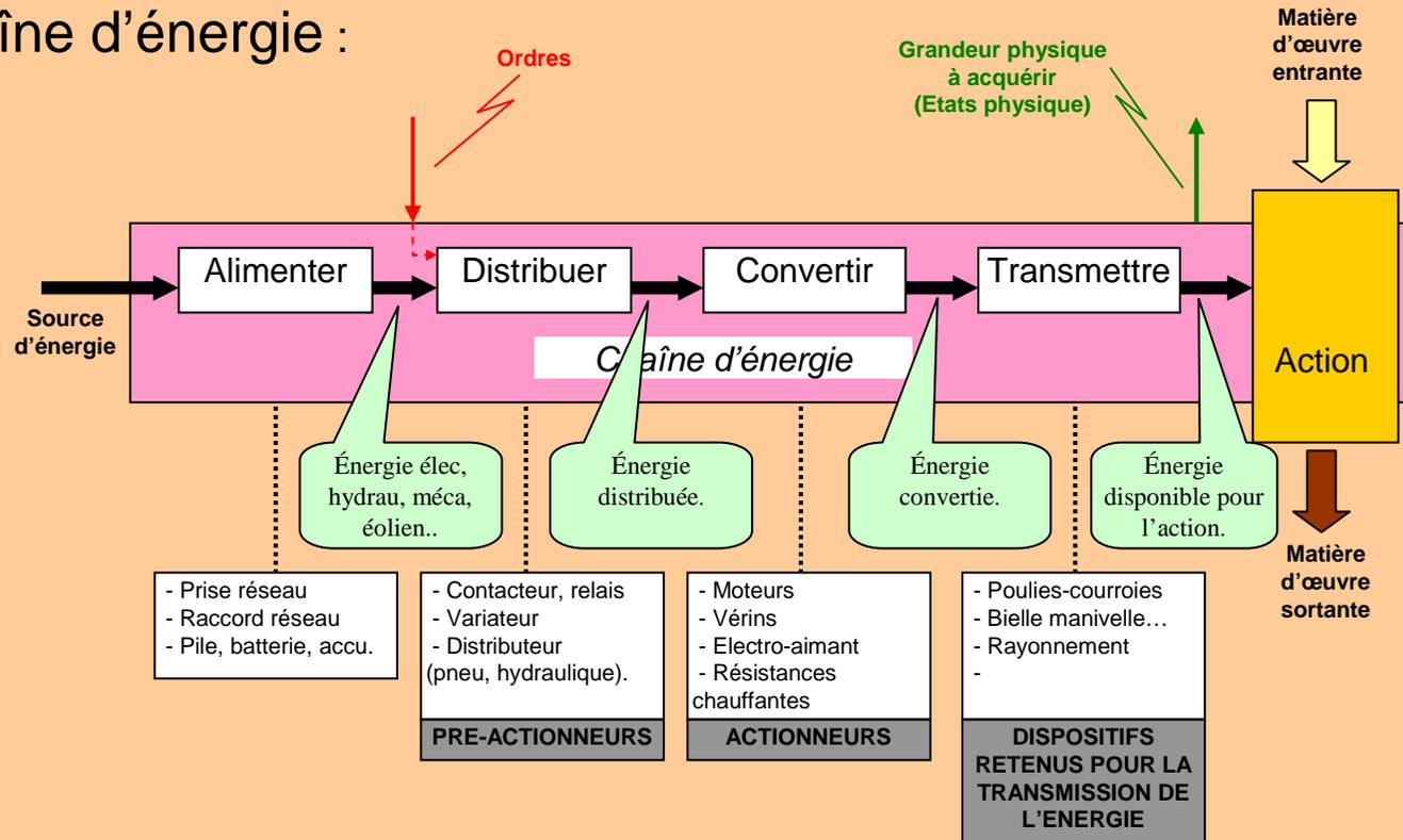
Les fonctions **Alimenter**, **Distribuer**, **Convertir**, **Transmettre** sont réalisées par des composants :
