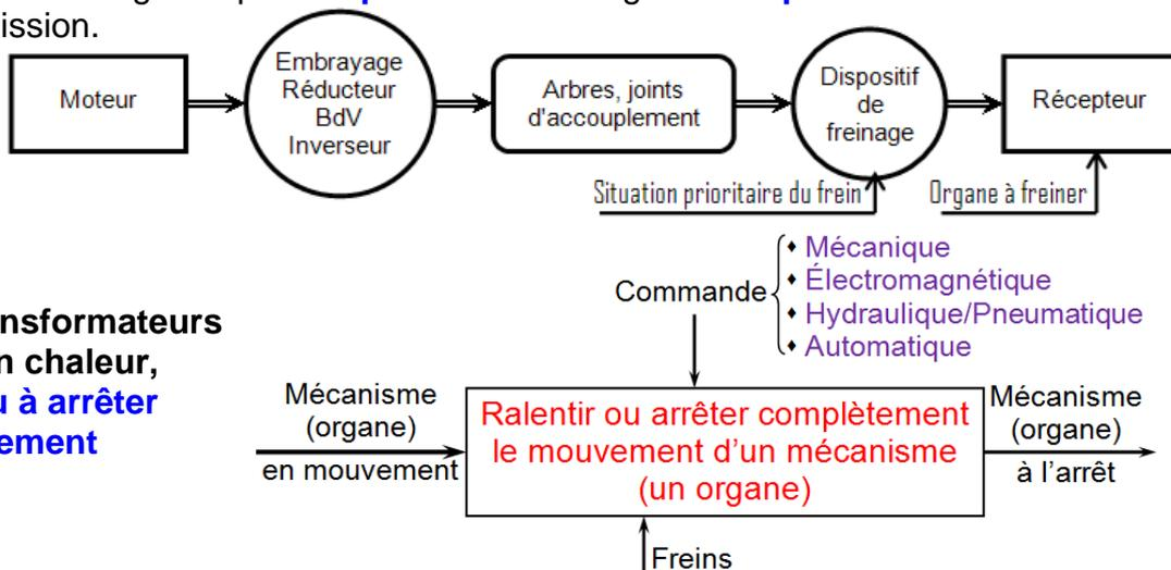
Les freins sont des transformateurs d'énergie mécanique en chaleur, et destinés à **ralentir ou à arrêter complètement le mouvement d'un mécanisme**.
