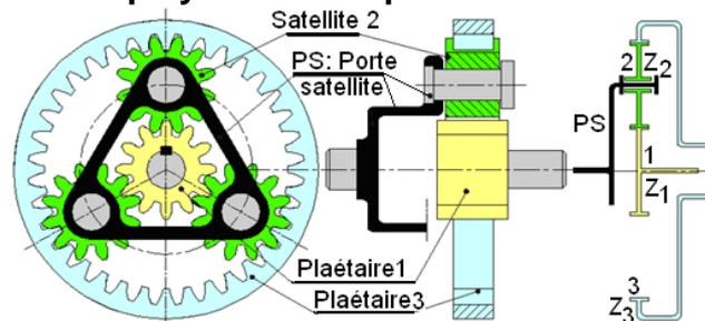
Train épicycloïdal simple à trois satellites c'est la configuration la plus répandue utilisant un satellite avec une seule roue dentée.
