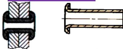
Le rivet creux est plus léger et facile à riveter. Il est utilisé dans les domaines aéronautiques...
