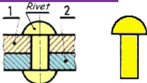
Le montage d'un rivet massif nécessite une intervention des deux cotés. Il peut avoir une tête cylindrique, bombée, fraisée.
