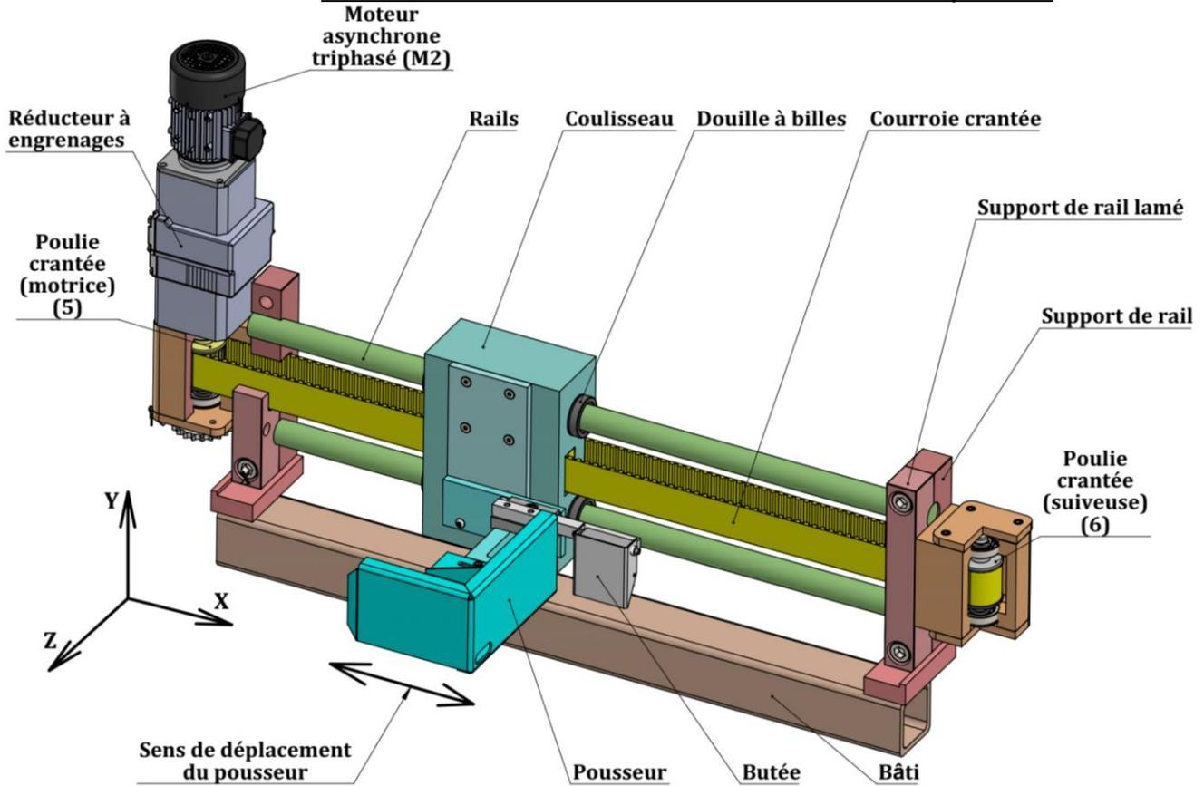
Chaîne cinématique du mécanisme d'entraînement en translation du pousseur :
