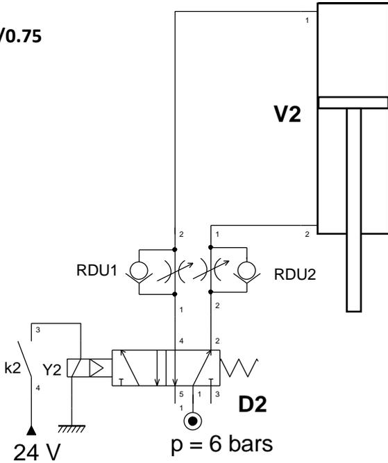
Q.23. Représentation du distributeur D2 et indication du parcours de l'air sous pression dans le cas où k2 est fermé.
