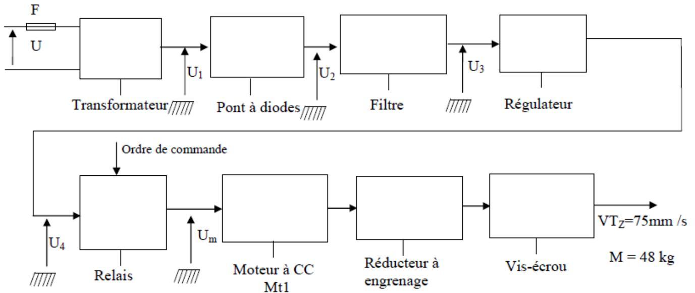
Schéma du montage du moteur **Mt1**
