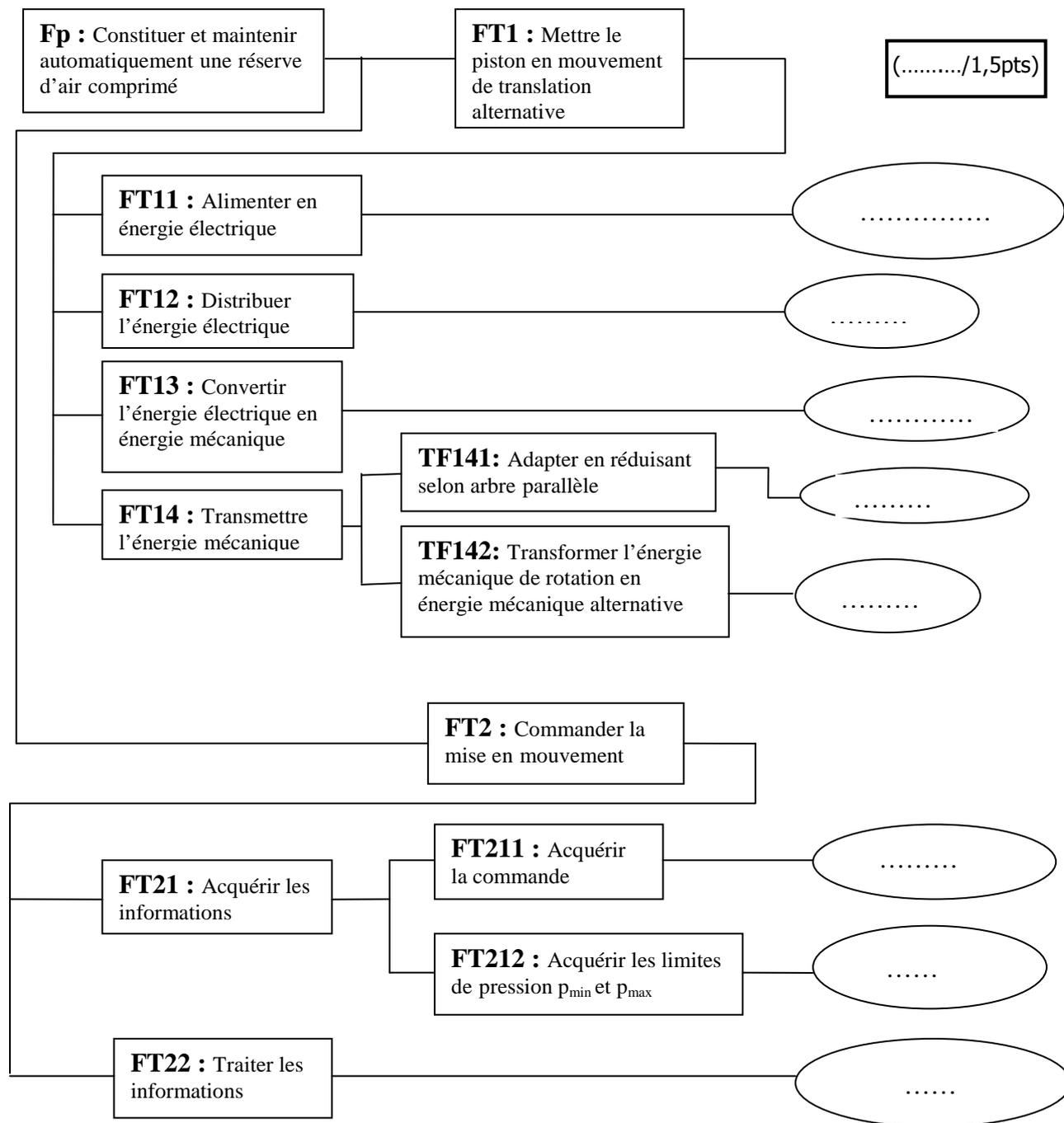
121- Compléter le graphe des transmissions mécaniques ci-dessous par l'indication de la nature du mouvement de chacun des éléments par rapport au corps repère 1.
