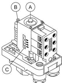
C'est un pressostat pour circuit de puissance à écart réglable.
