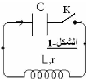
نعتبر التركيب الممثل في وثيقة الشكل-1 والمكون من مكثف مشحون سعته  $C$  والتوتر بين مربطيه  $U_0=10V$ ، ووشيعة معامل تحريرها  $L$  ومقاومتها مهملة، وقاطع تيار  $K$ . عند لحظة  $t=0$  نغلق قاطع التيار.
