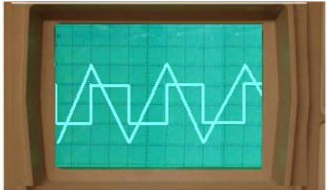
الكسح الأفقي المستعمل :  $0,5ms/div$  . الحساسرة الرأسية: بالنسبة للمدخل  $Y_2$  :  $1V/div$  وبالنسبة للمدخل  $Y_1$  :  $0,05V/div$
