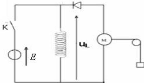
عند غلق قاطع التيار  $K$  يمر تيار كهربائي في الوشيعه . يمنع الصمام الثنائي المركب في المنحنى الحاجز مرور تيار كهربائي في المحرك عند فتح قاطع التيار  $K$  يشتغل المحرك فيرتفع الجسم  $S$  .
