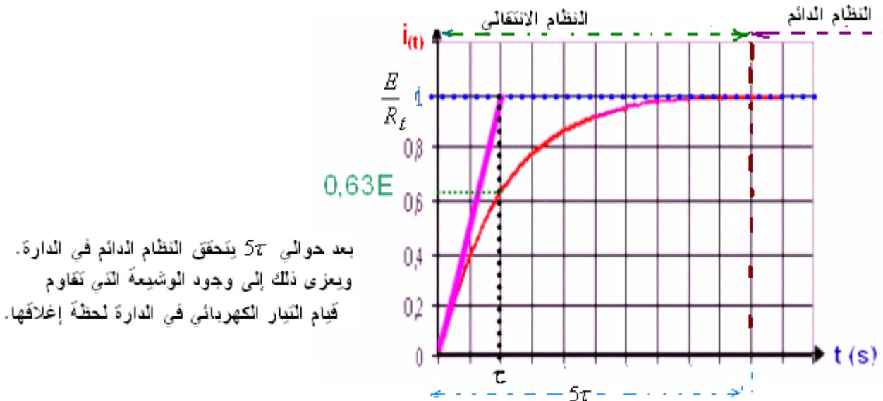
بعد حوالي  $5\tau$  يتحقق النظام الدائم في الدارة. ويعزى ذلك إلى وجود الوشيعنة التي تقاوم قيام التيار الكهربائي في الدارة لحظة إغلاقها.
