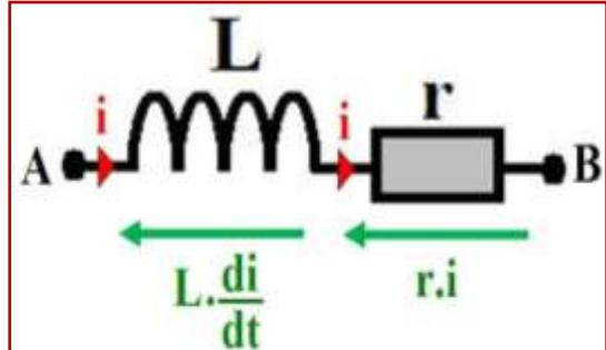
بحيث:  $u_L(t)$  بالفولط (V) -  $i$  شدة التيار بالأمبير (A) -  $r$  مقاومة الوشيعة بالأوم ( $\Omega$ ) -  $L$  معامل تحريض الوشيعة بالhenry (H) و يتعلق بطول الوشيعة ومساحتها و عدد لفاتها و كذلك بطبيعة الوسط الذي توجد فيه.
