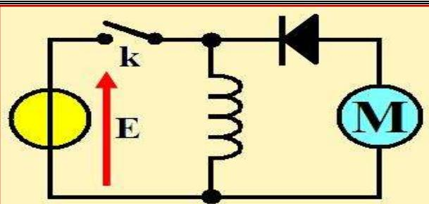
نعتبر التركيب التجاريي جانبه، و المكون من وشيعة معامل تحريضها  $L$  و محرك  $M$  ومولد  $G$ . نغلق قاطع التيار  $k$  فيمر في الوشيعة تيارا كهربائيا، في حين أن الصمام الثنائي المركب في المنحى الحاجز يمنع مرور التيار الكهربائي للمحرك، و بعد فتح قاطع التيار يشتغل المحرك لمدة زمنية.
