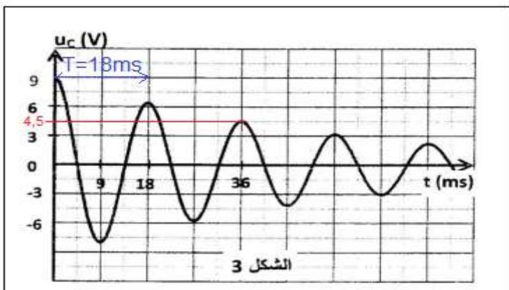
إذن الطاقة الكلية للدارة الكهربائية في هذه اللحظة تساوي الطاقة المخزنة في المكثف .
