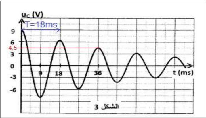
إذن الطاقة الكلية للدارة الكهربائية في هذه اللحظة تساوي الطاقة المخزونة في المكثف .
