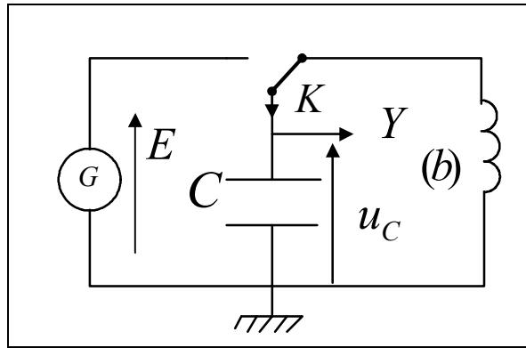
2-2: سبب خمود التذبذبات هو وجود مقاومة الوشيعة  $r$  بحيث تتبدد الطاقة بمعنى جول . (0,25)
