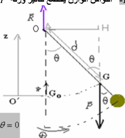
$$\ddot{\theta} + \frac{(m_1 + m_2) \cdot g \cdot d}{J_A} \cdot \theta = 0 \quad \text{وهي المعادلة التفاضلية التي تتحققها } \theta \text{ في حالة التدببات الصغرى.}$$
