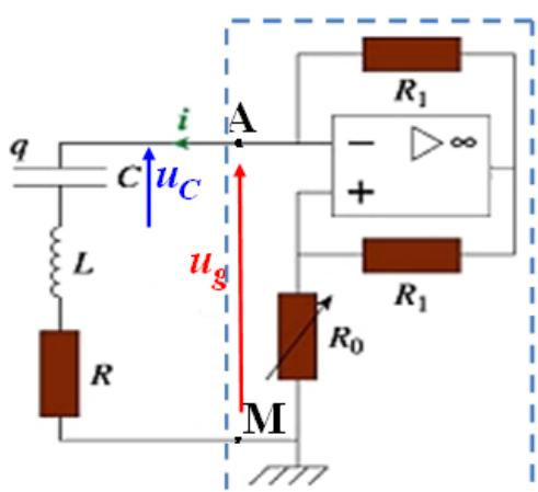
**٤- صيانة تذبذبات:** يمكن صيانة تذبذبات دارة  $RLC$  متواالية والحصول على توتر متذبذب ذي وسع ثابت ، باستعمال جهاز يزود الدارة بطاقة تعوض الطاقة المبددة في الدارة بمفعول جول .
