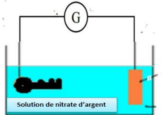
On veut argenter une **clef métallique** en couvrant sa surface avec une couche mince d'argent de masse  $m$ . Pour atteindre cet objectif , on réalise une électrolyse dont la clef constitue l'une des électrodes . La deuxième électrode en graphité inattaquable (ne réagit pas) dans les conditions de l'expérience . L'électrolyte utilisé est une solution aqueuse de nitrate d'argent ( $\text{Ag}^+_{(\text{aq})} + \text{NO}_3^-_{(\text{aq})}$ ) de volume  $V = 500 \text{ mL}$  (voir figure).
