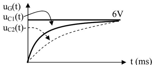
c. La différence entre les deux courbes obtenues est que la deuxième montre que le système répond plus lentement à la charge du condensateur avec une résistance deux fois plus grande.
