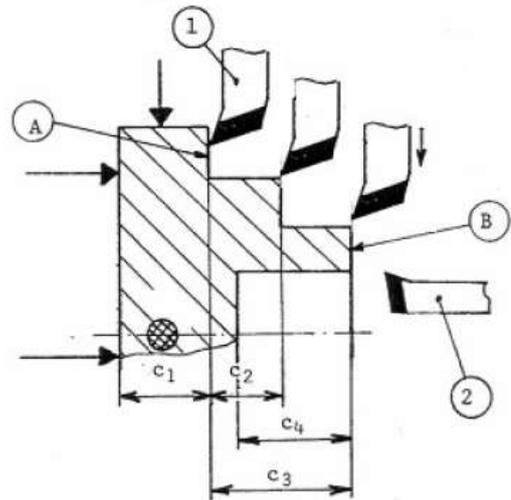
*Figure 5.3 : Cotes machines en mode incrémental*
