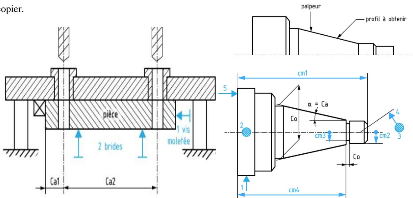
Figure 5.5 : Cotes appareillage
