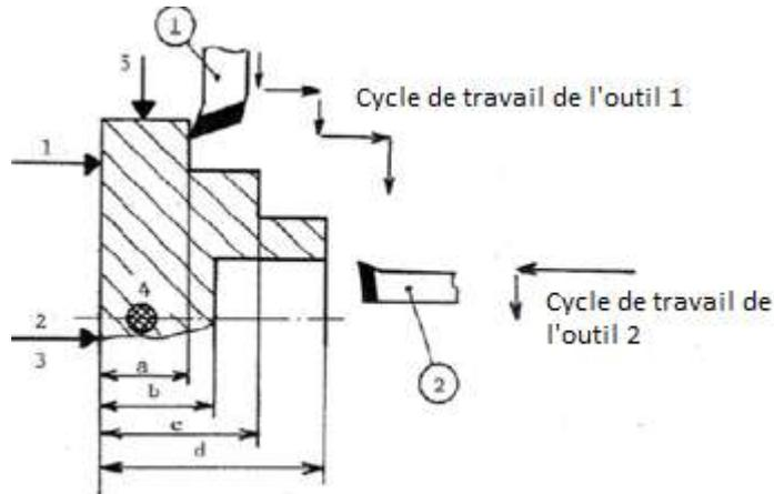
*Figure 5.2 : Cotes machines en mode absolu*
