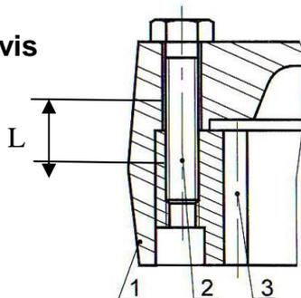
La vis (2) assure le maintien en position des pièces (1) et (3)
