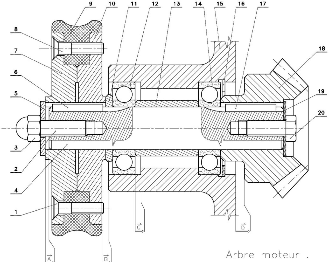
Repasser en rouge la surface cylindre/cylindre entre la pièce (18) et la pièce (4).
