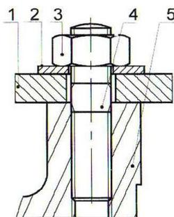
Le goujon (4) et l'écrou (3) assurent le maintien en position des pièces (1) et (5)
