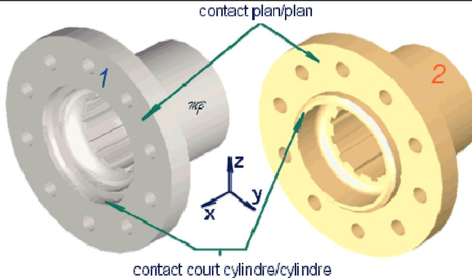
Quels degrés de liberté le contact plan/plan entre la pièce 1 et la pièce 2 **élimine**-t-il?
