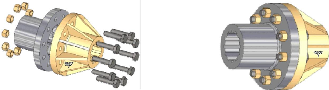
La pression de contact assurée par les boulons assure le maintien en position.
