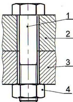
Le boulon {1;4} assure le maintien en position des pièces (2) et (3)
