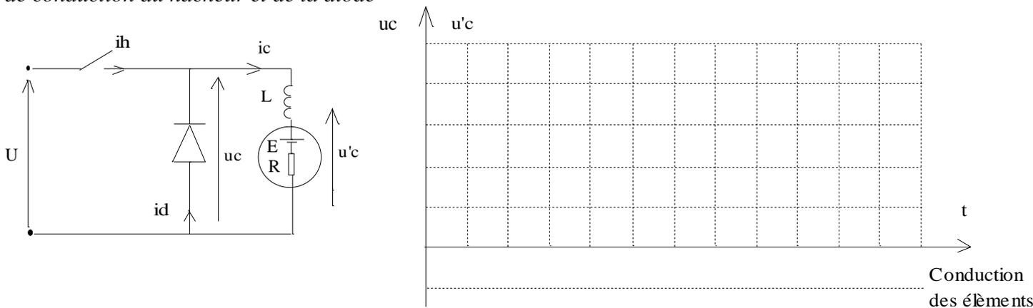
2. Calculer  $u_{c\text{moy}}$  et la puissance fournie par le hacheur.
