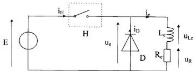
L'aimantation du séparateur se fait grâce à un électroaimant, assimilable à une bobine en série avec une résistance. Les concepteurs ont prévu que l'aimantation du séparateur puisse être variable en fonction du type de déchets à traiter. Cette variation d'aimantation est réalisée grâce à un hacheur série.
