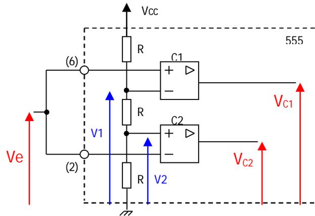
On considère l'étage d'entrée du 555, composé par le pont diviseur et les deux comparateurs C1 et C2. On relie les entrées (2) et (6). On se propose d'étudier l'évolution de  $V_{C1}$  et  $V_{C2}$  dans ce cas-là.
