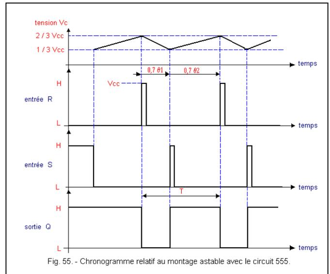
Fig. 55. - Chronogramme relatif au montage astable avec le circuit 555.
