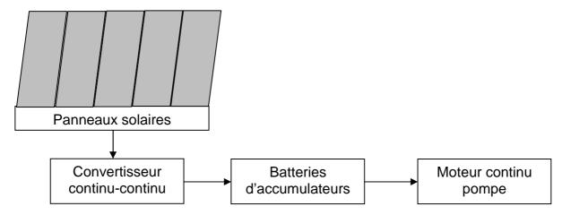
L'énergie électrique produite par les panneaux solaires peut être utilisée immédiatement, ou stockée dans des batteries d'accumulateurs, par l'intermédiaire d'un convertisseur continu-continu.
